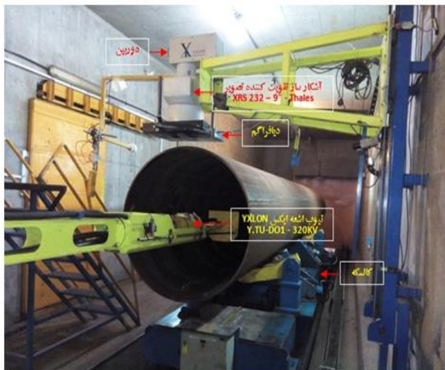
شکل (۳) تصویر سیستمهای رادیوگرافی: مجموعه آشکار ساز صفحه تخت و آشکار ساز تقویت کننده تصویر
