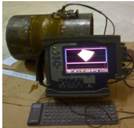
شکل (۱): لوله انتقال ۱۲ اینچ دارای جوش سر-به-سر و نمایی از دستگاه آرایه فازی
