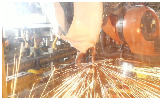
شکل ۷- مونتاژ ورق ها روی شابلن مخصوص حین انجام فرایند جوشکاری مقاومتی نقطه ای
