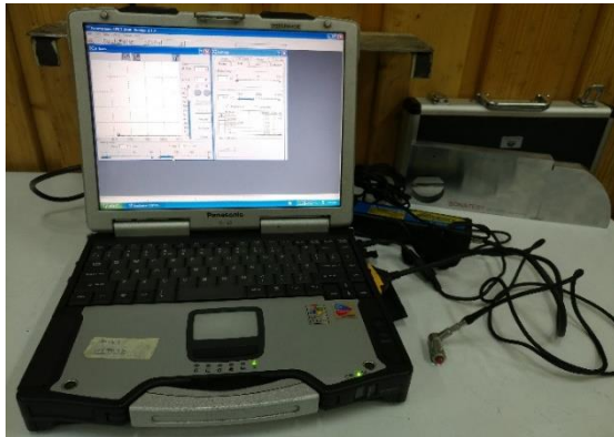
شکل ۸- دستگاه آلتراسونیک مورد استفاده جهت ارزیابی جوش مقاومتی نقطه‌ای
